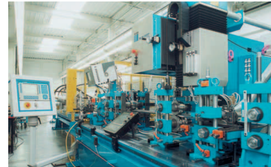
Línea de soldadura de tubos por láser para vigas de intrusión de automoción
