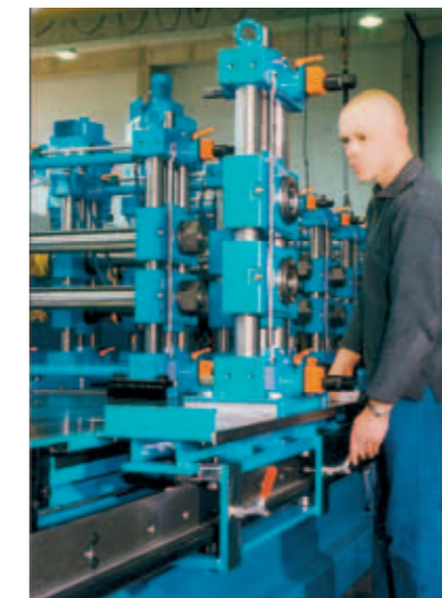
Sustitución manual de rodillos
