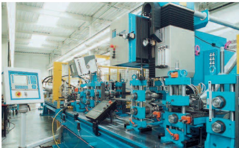
Установка лазерной сварки труб для профилей защиты от боковых ударов
