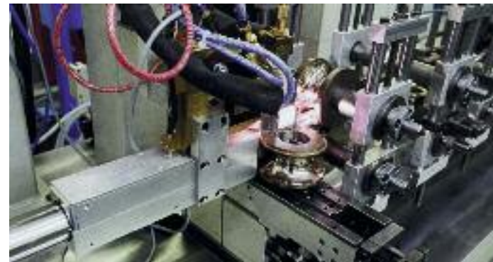
薄肉チューブのティグ溶接
