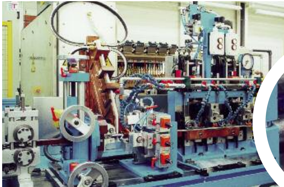
窓枠スペーサーラインの高周波パイプ溶接機
