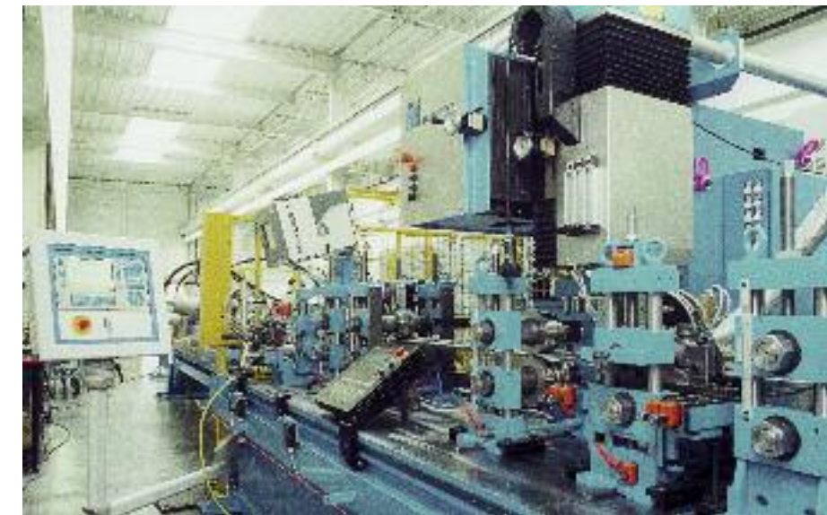
自動車の補強材用レーザーチューブ溶接ライン
