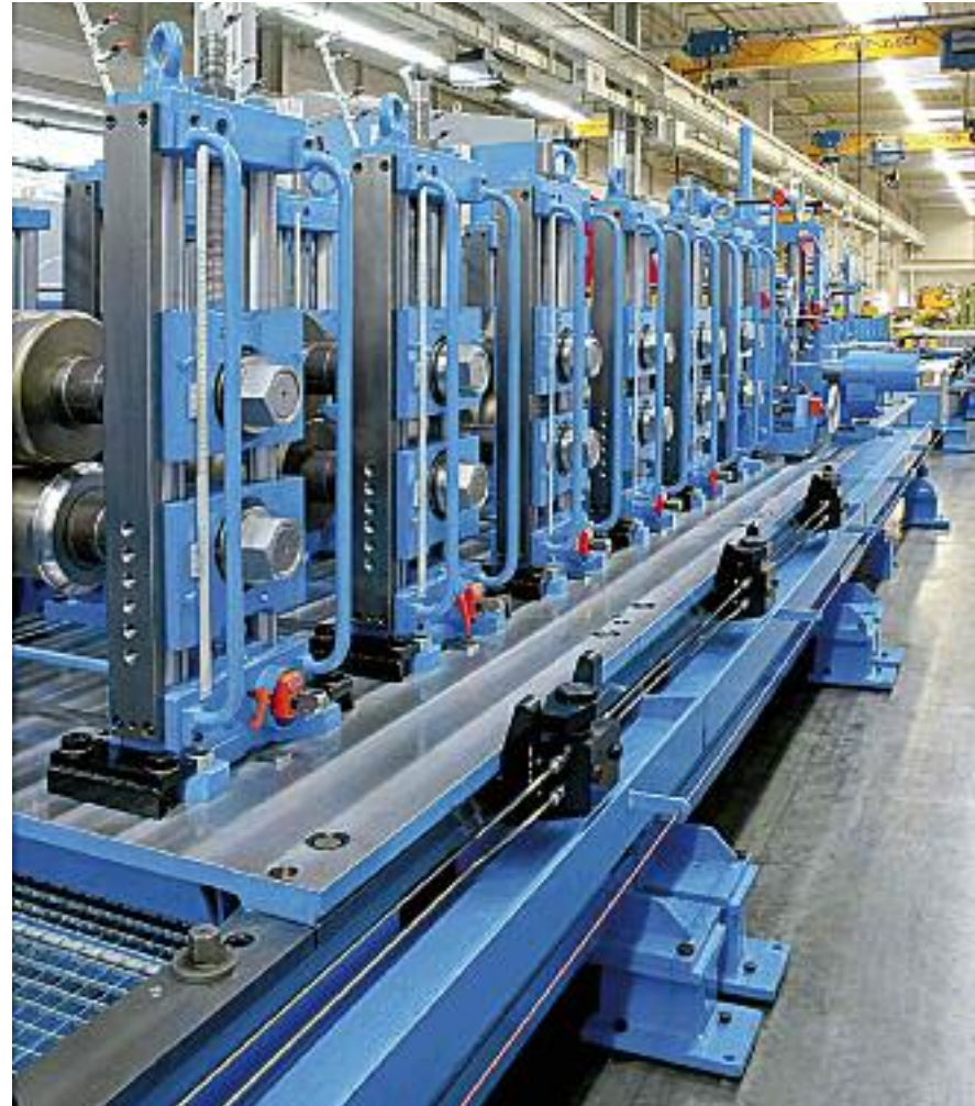
形式P3,200の成形機、最大断面寸法600×200mm、最大材料厚5mm
