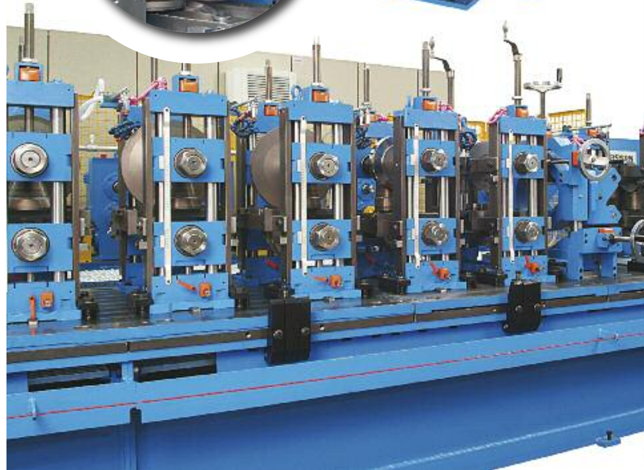
U型、C型、Z型、Σ型と、幅広く対応できる超フレキシブルなロール成形機
