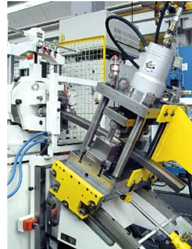
超高張力鋼プロファイルの切断
