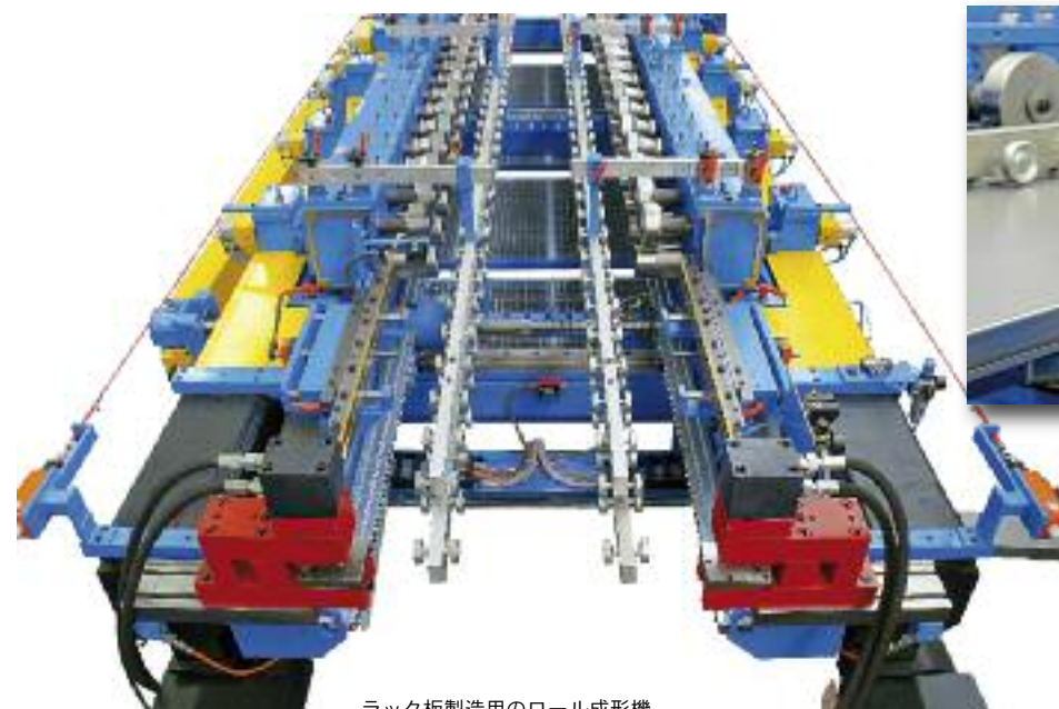
ラック板製造用のロール成形機
