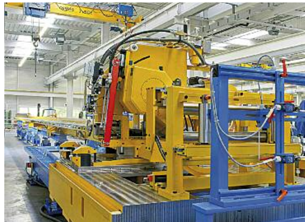
切断とパンチングを同時に行う可動式の切断機
