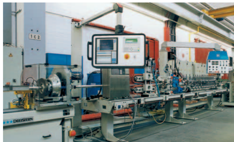
Impianto per la saldatura di tubi a parete sottile
