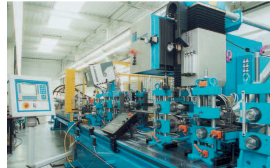
Impianto di saldatura laser per la produzione di barre anti intrusione laterali
