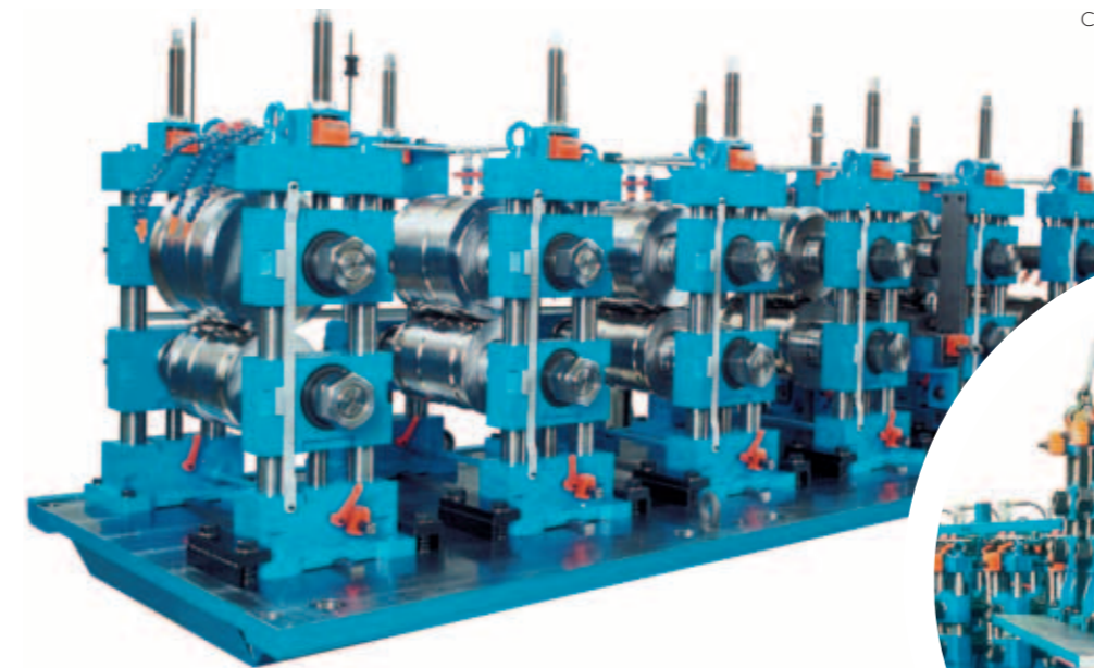
Stations de profilage montées sur plaques
