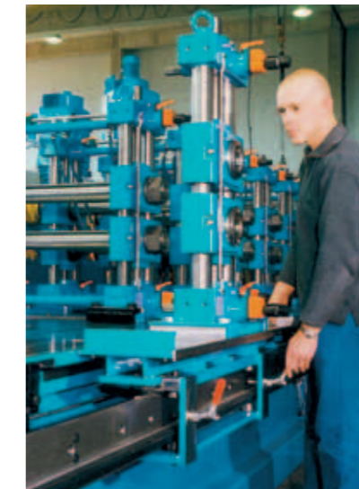
Changement manuel des outils à galets de formage
