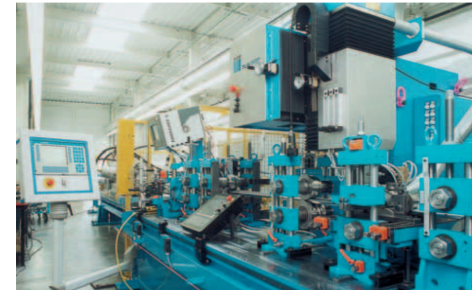
Laser-Rohrschweißanlage für Seitenaufprallschutz-Profile
