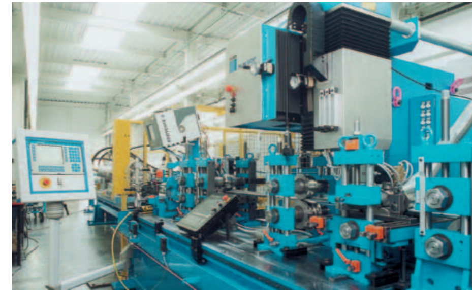
Urządzenie do spawania laserowego rur do produkcji profili samochodowych wzmocnień bocznych
