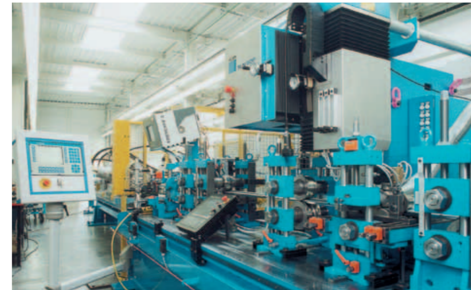
用于车身侧面加强梁生产的激光焊接
