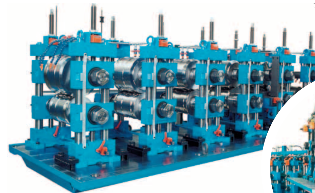
Профилегибочные клетки, установленные на сменной плите
